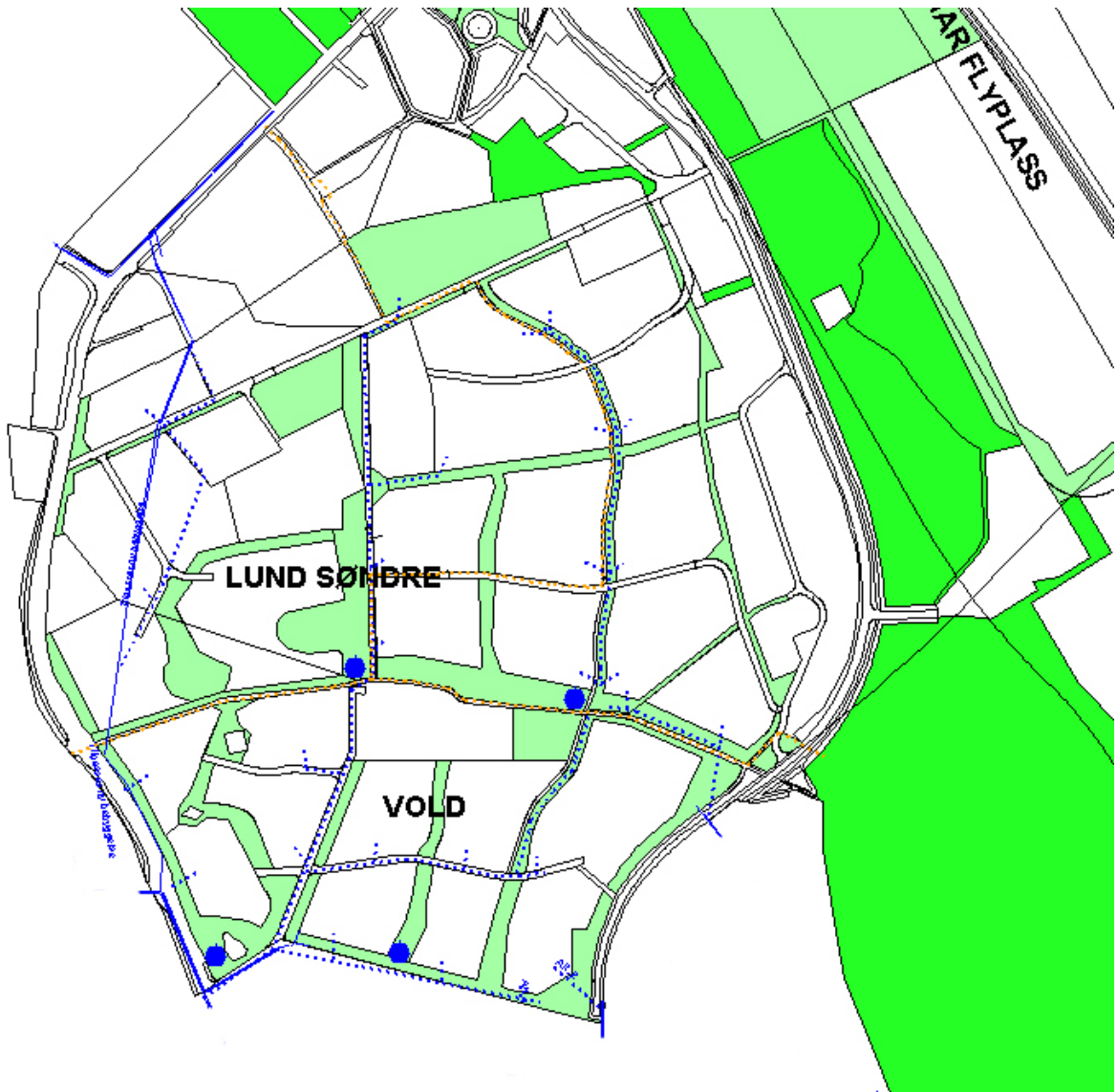
Figur: Viser hovedtrase vann-, avløp- og el-trasé
